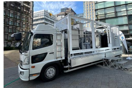
災害への備え (100t級可搬式ろ過設備)
