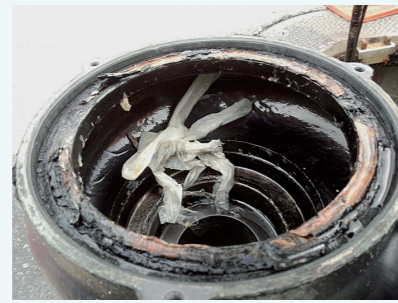
【写真】実際に下水道管に詰まっていたものの例 (ウェットティッシュ、ゴム手袋、タオル)
