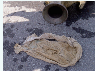
【写真】実際に下水道管に詰まっていたものの例 (ウェットティッシュ、ゴム手袋、タオル)
